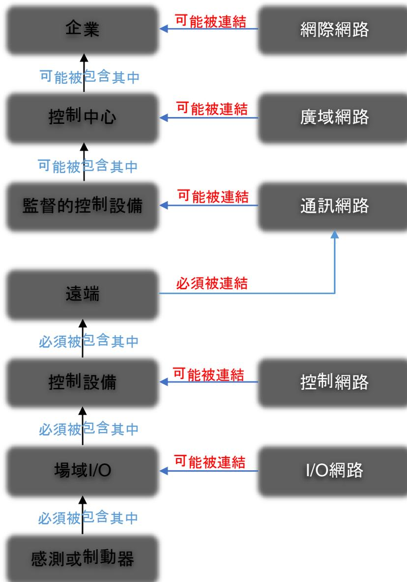
圖 6 SCADA 的資產模型
